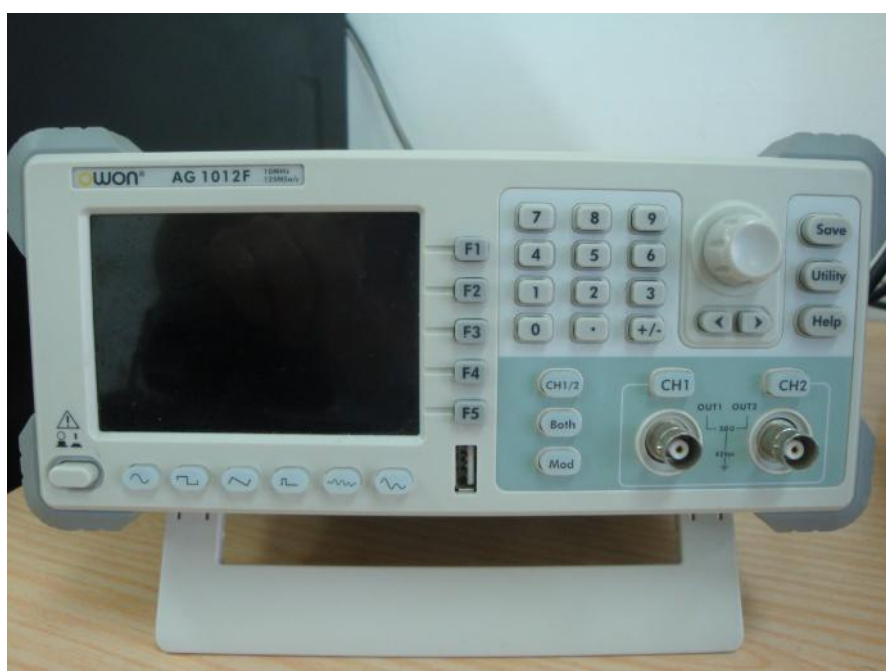
Figura 4: Panoul față al generatorului OWON AG1012F
