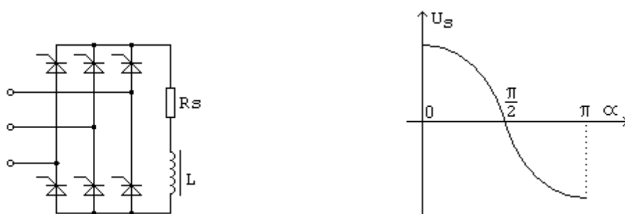
Figura 5.11: Redresor trifazat comandat, cu sarcină predominant inductivă
